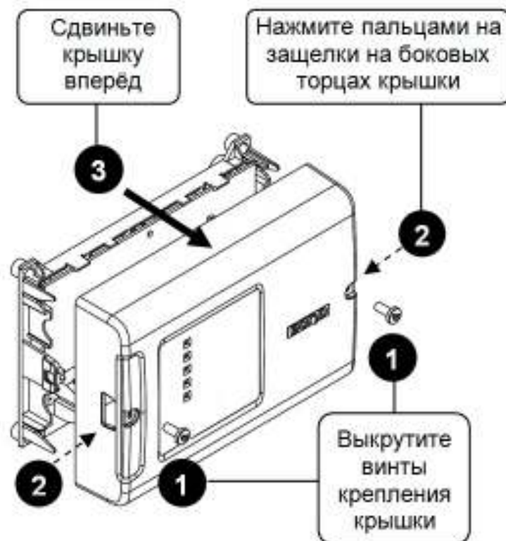
Рисунок 8-2 Снятие крышки
