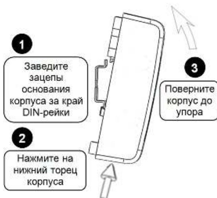
Рисунок 8-3 Крепление на DIN-рейку
