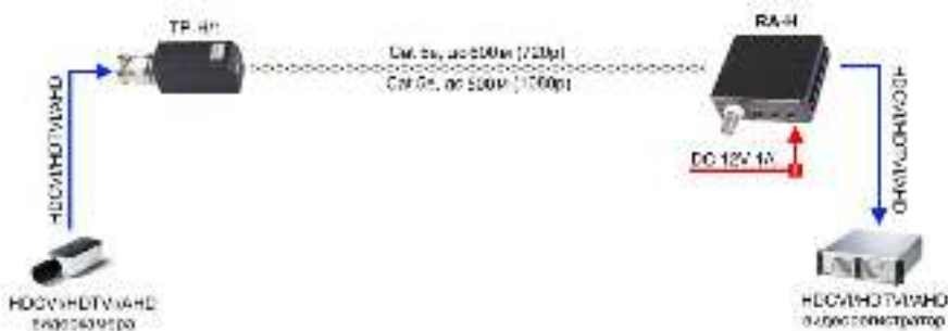
Рис.5 Типовая схема подключения активного приемника RA-N и пассивного приемопередатчика TP-N/1
