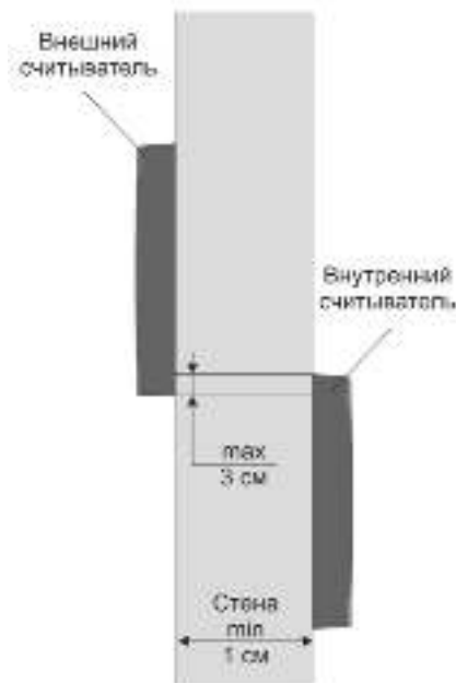
Рисунок 5. Крепление считывателей с разнесением по вертикали
