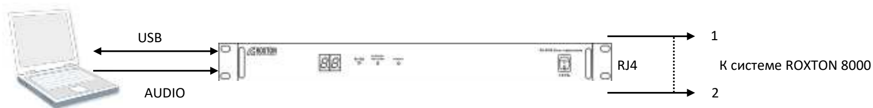
Схема подключения ПК к системе ROXTON 8000
