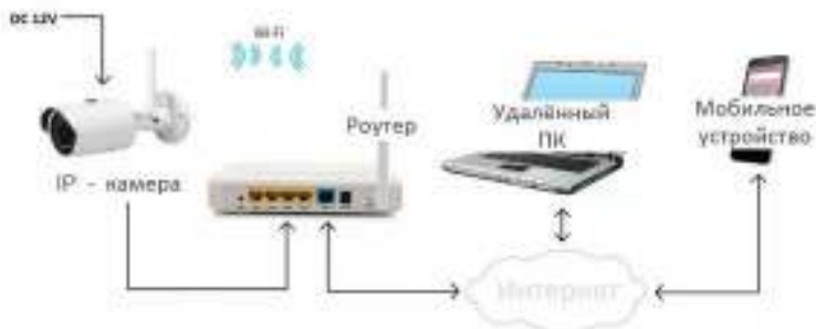
Рис. 2.2 Подключение через роутер
