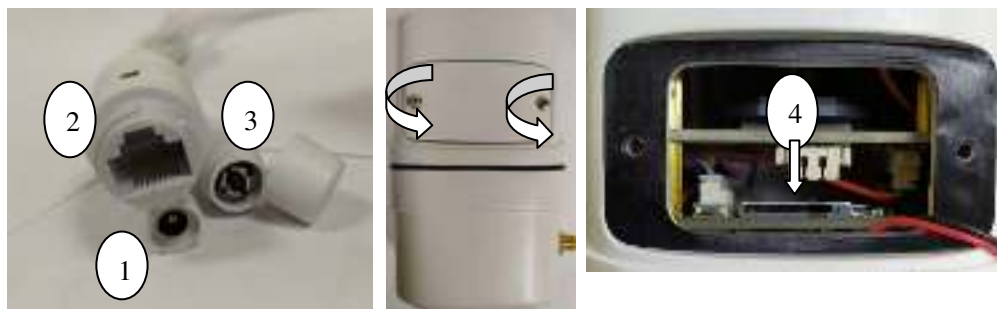
Рис. 1.2 Интерфейсы IP камеры
