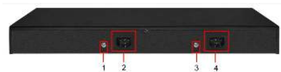
Рис.3 Коммутатор SW-24G4X-1L-I, разъемы и кнопки на задней панели
