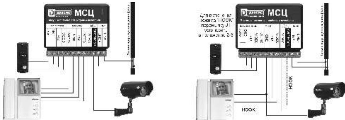
При подключении по правой схеме, не забудьте перевести переключку J1 в положение 2-3, при этом назначение клеммы 10 переключится из GND во вход сигнала HOOK. Общий провод сигнального кабеля подъездного видео нужно подключать к любой другой клемме GND (2 или 6) в такой конфигурации. Данная схема подключения действительна только для модулей сопряжения МСЦ версии 1е и выше.
