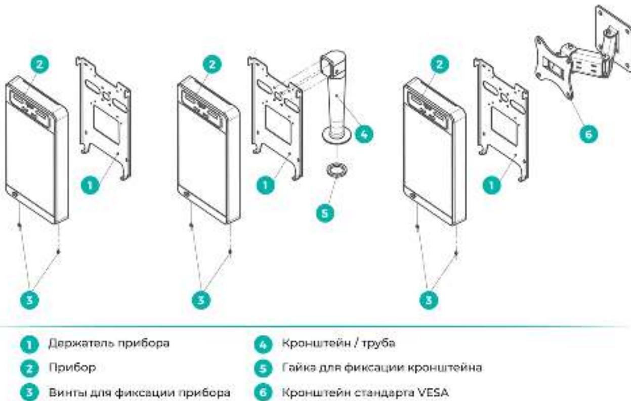
**1** Держатель прибора**2** Прибор**3** Винты для фиксации прибора**4** Кронштейн / труба**5** Гайка для фиксации кронштейна**6** Кронштейн стандарта VESA
