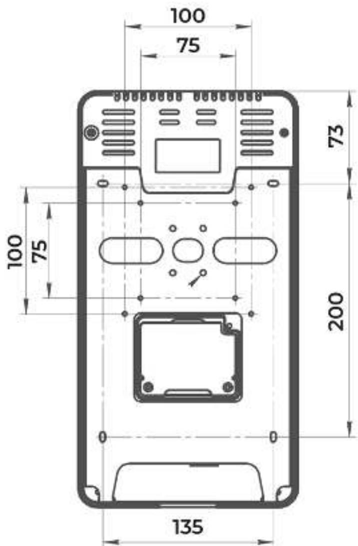
Схема установки прибора на держатель показана на рисунке ниже.
