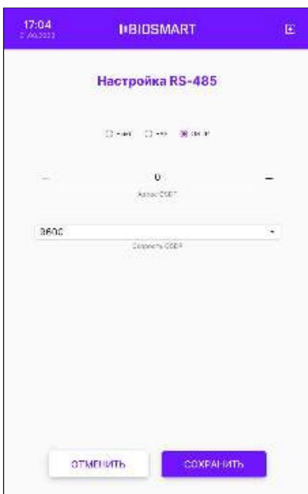
В блоке **Адрес OSDP** укажите адрес терминала от 0 до 126. Если к контроллеру по одной линии RS-485 подключено несколько терминалов, то у каждого терминала должен быть уникальный адрес.
