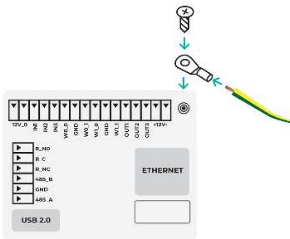
Второй конец кабеля соединяется с заземляющим устройством.
