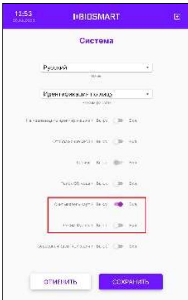
При работе терминала со сторонним контроллером по интерфейсу Wiegand предусмотрен специальный режим Bypass. В этом режиме считанный код RFID-карты, независимо от того, присутствует он в базе данных или отсутствует, передается на сторонний контроллер через выходной Wiegand-интерфейс терминала. Режим Bypass используется, когда необходимо обеспечить проход по RFID-картам через стороннюю систему контроля и управления доступом, минуя систему Biosmart.
