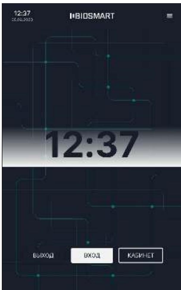
Для включения данного режима перейдите в меню **Настройки – Система** выберите режим работы **Вход/выход по кнопкам** и установите переключатель **Кабинет** в положение **Вкл.**
