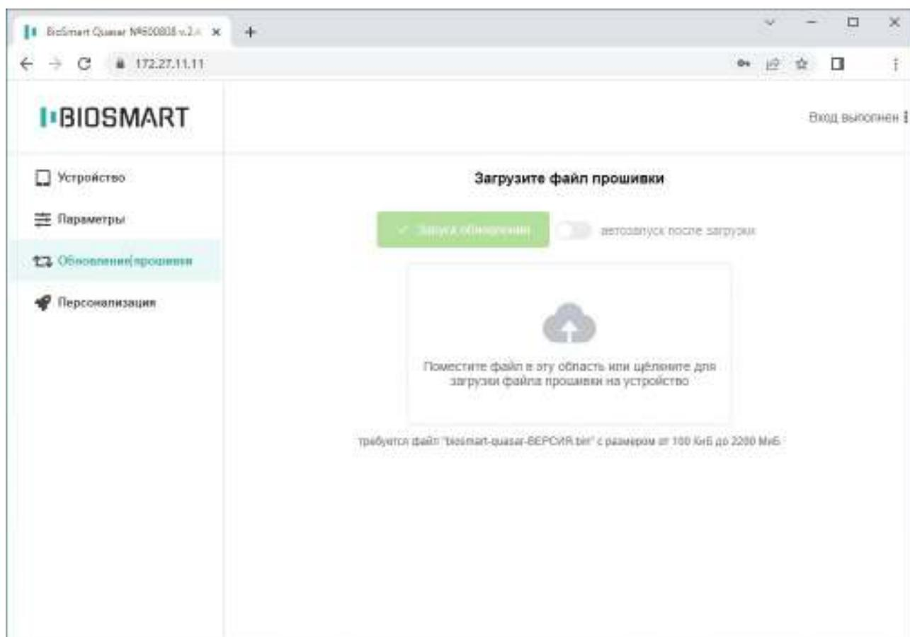
Переместите файл новой версии ПО в выделенную область или воспользуйтесь мастером загрузки. Индикатор процесса загрузки покажет состояние загрузки файла. Включите переключатель **автозапуск после загрузки** и обновление ПО начнётся сразу после завершения загрузки либо дождитесь окончания загрузки и нажмите **Запуск обновления**.
