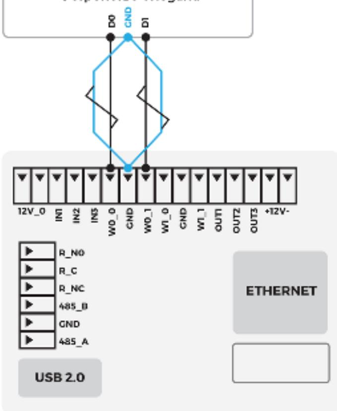
Линии данных DATA 0 (контакты W0\_0 или W1\_0) и DATA 1 (контакты W0\_1 или W1\_1) должны быть попарно перевиты с линией GND. Линия GND у терминала и подключаемого устройства должна быть общей либо должен использоваться общий источник питания 12 В.
