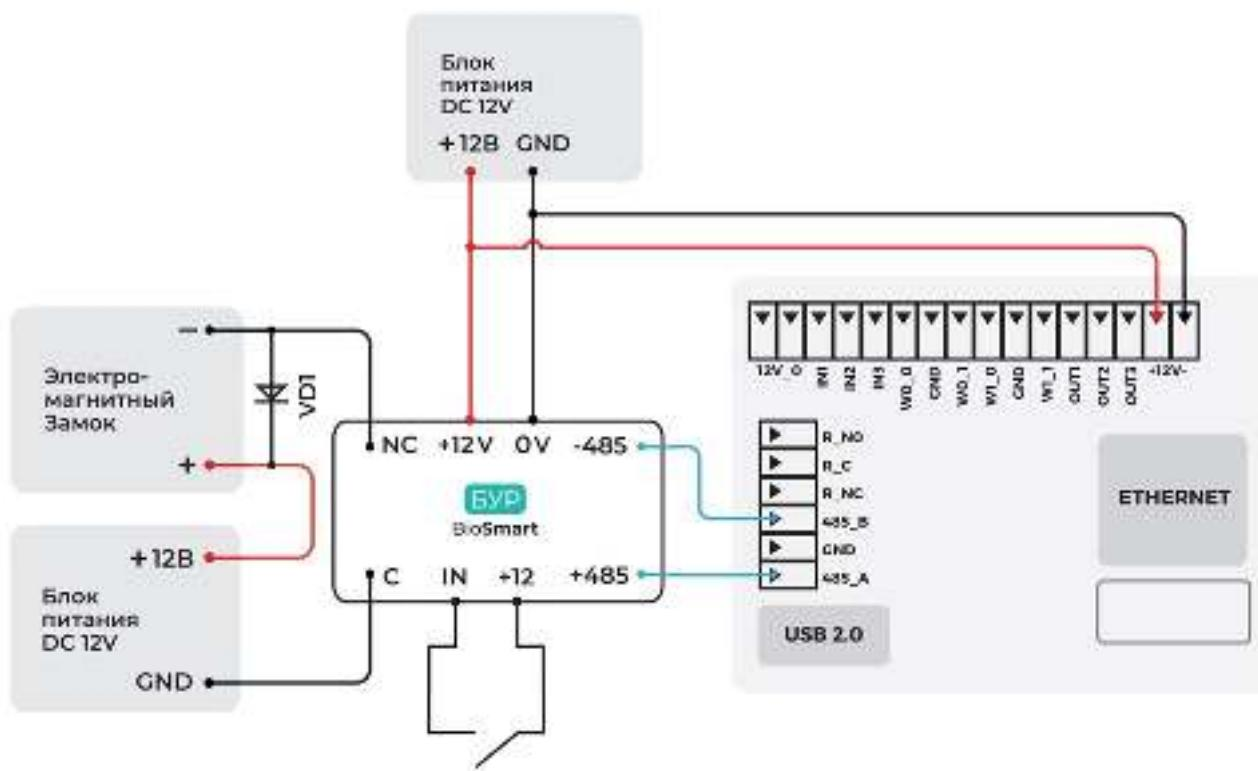
Для подключения БУР BioSmart соедините контакты **+ 485** и **- 485** БУР с контактами **485\_A** и **485\_B** терминала.
