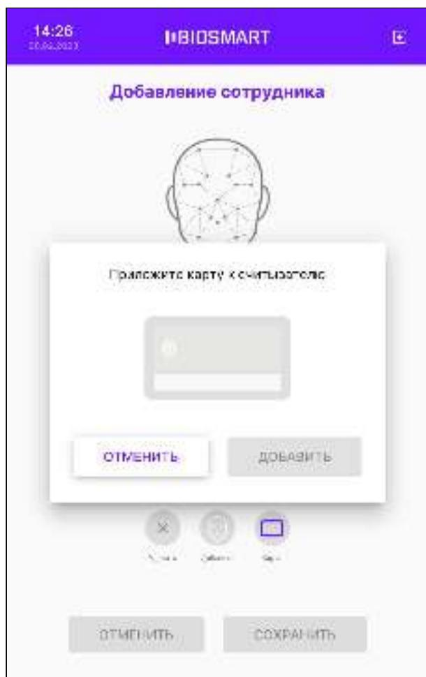
Приложите RFID-карту к считывателю терминала. Считыватель расположен под экраном терминала. После прикладывания RFID-карты появится код карты и сообщение «Карта успешно считана».
