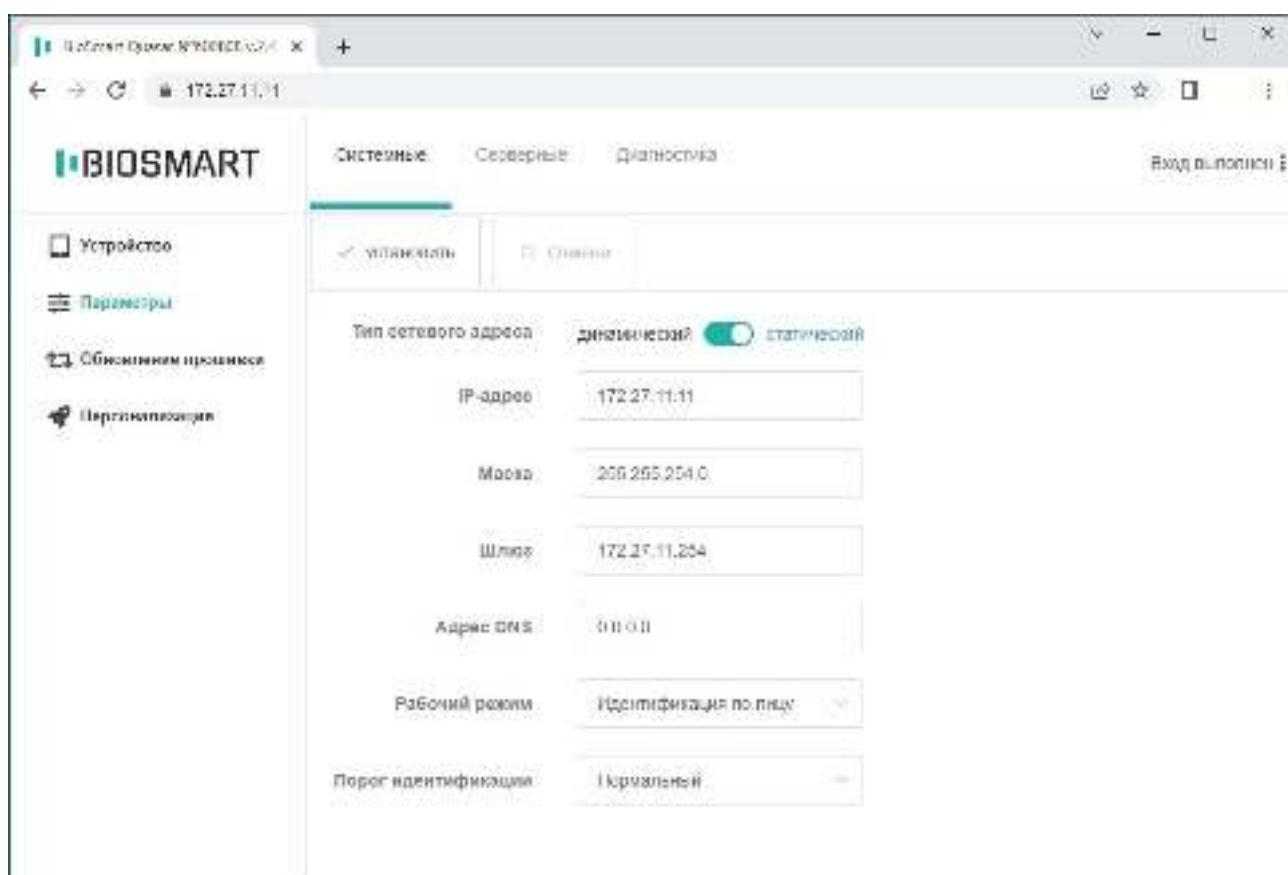
Параметр **Порог идентификации** определяет порог совпадения биометрических данных, полученных в процессе идентификации, с биометрическим шаблоном, хранящимся в базе данных. Порог идентификации, соответствующие ему вероятность ошибочного предоставления доступа (FAR) и вероятность ложного отказа в доступе (FRR) для разных математических алгоритмов показаны в таблице:
