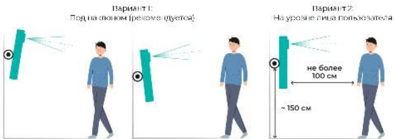
Вариант монтажа под наклоном подходит при работе с пользователями, рост которых сильно отличается друг от друга. Чтобы попасть в объектив камеры, пользователь может встать подальше (не более 1 метра) или подойти поближе.
