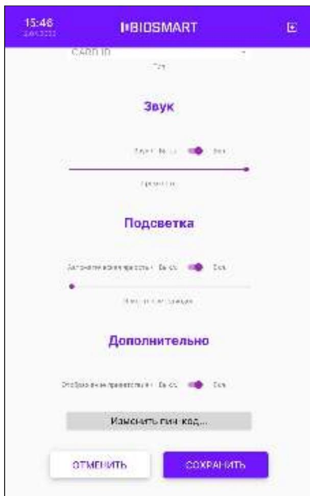
В разделе **Звук** переместите ползунок **Громкость** для изменения громкости звуковых сигналов. Для включения или выключения звуковых сигналов переместите переключатель **Звук** в положение **Вкл.** или **Выкл.**
