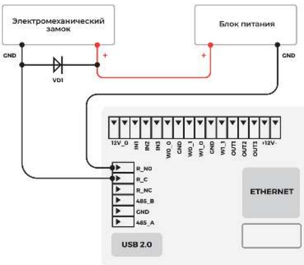
Подключение двух терминалов к одному электромеханическому замку осуществляется в соответствии со схемой ниже.
