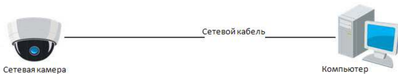
Рисунок 1.1: Подключение с использованием перекрестного кабеля.
