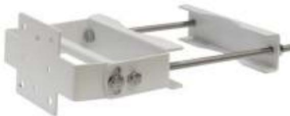
Кронштейн ST-LR300BR предназначен для монтажа УВЧ считывателей ST-LR300, ST-LR320 и ST-LR321 на трубу диаметром до 120 мм. Устройство имеет регулировку угла наклона считывателя.
