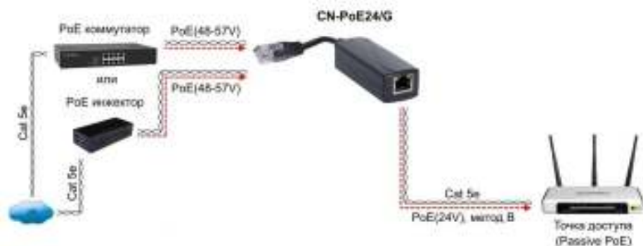
Рис.3 Типовая схема подключения конвертера CN-PoE24/G
