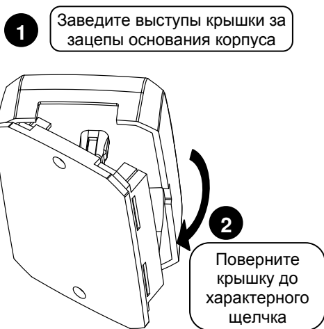
Рисунок 3. Установка крышки С2000-АСР2
