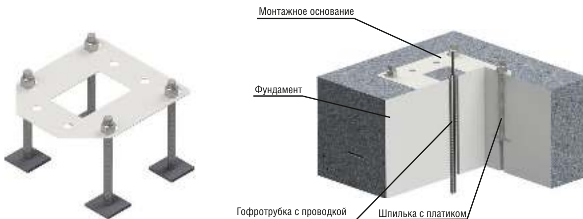
Рисунок 7.1.1 Устройство фундамента с монтажной пластиной
