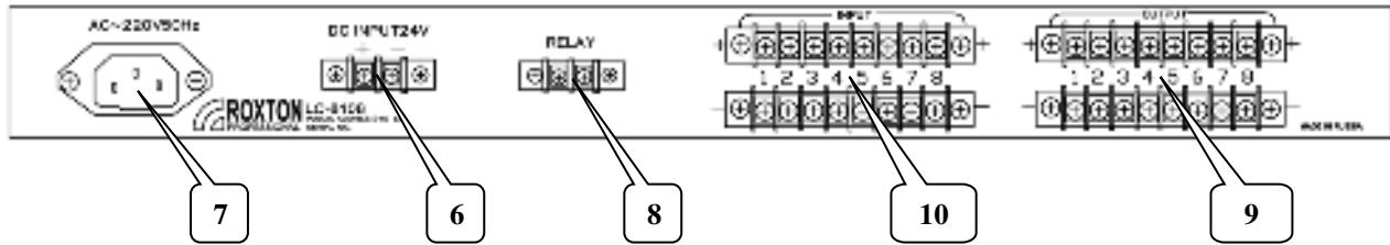
**6. Клеммы питания.** На данные клеммы подается напряжение питания 18 - 24В
