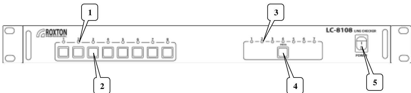
**1. Индикаторы состояния соответствующего канала.** Состояние канала определяется согласно таблице
