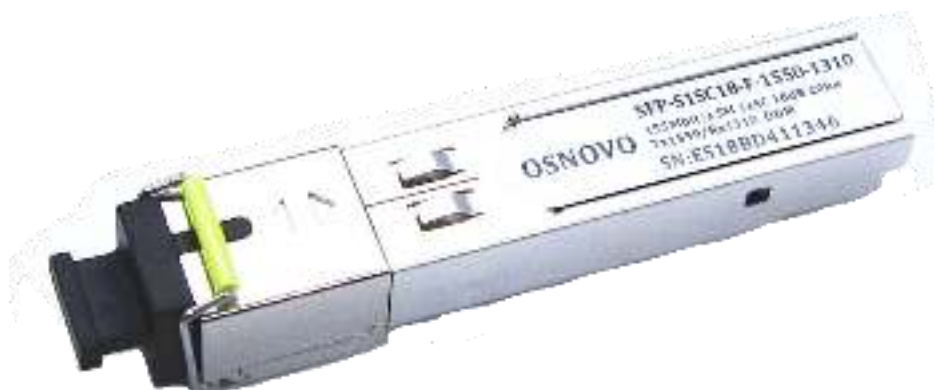
Рис.1 SFP модули, внешний вид на примере SFP-S1SC18-F-1310-1550, SFP-S1SC18-F-1550-1310 (модули с промышленным исполнением выглядят аналогично)
