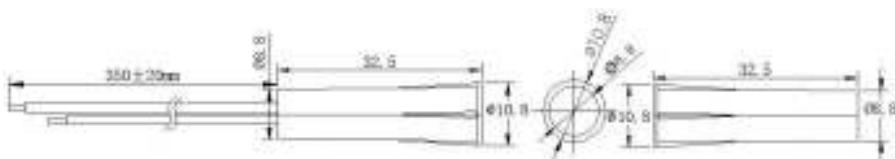
Извещатель магнитоконтактный ST-DM020NC-WT предназначен для контроля положения различных строительных конструкций (дверей, окон, люков, ворот и т.д.). Данное устройство может использоваться в системах охранной сигнализации или контроля и управления доступом.
