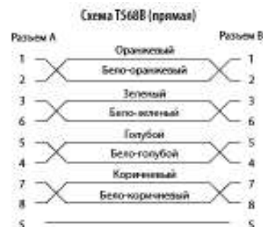
Рис. 1 Схема разводки патч-корда RJ-45 (8P8C)
