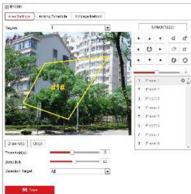
Рисунок 5-25 Настройка зоны обнаружения вторжения
