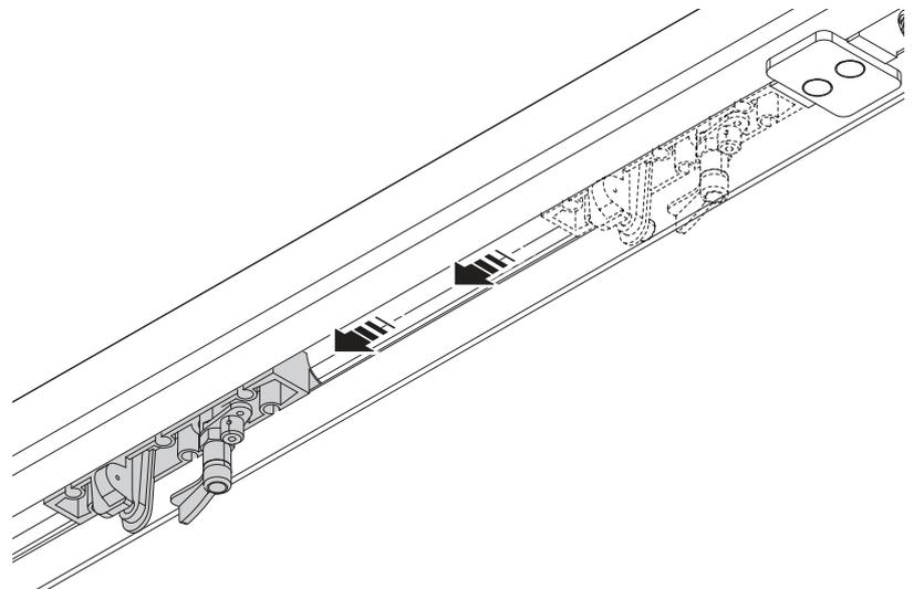
Прикрепите рычаг передачи к скользящему башмаку прилагаемым болтом.
