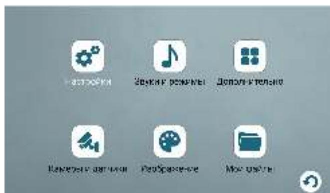
Для перемещения по разделам меню вращайте кнопку-колесо, а для входа в нужный раздел нажмите эту кнопку. В выбранном разделе нужный параметр можно выбрать нажатием на кнопку-колесо, а изменить значение – прокруткой кнопки-колеса.
