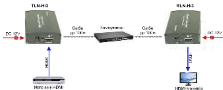
Рис.5 Схема подключения комплекта TLN-Hi3+RLN-Hi3 в режиме «точка-точка» через гигабитный коммутатор
