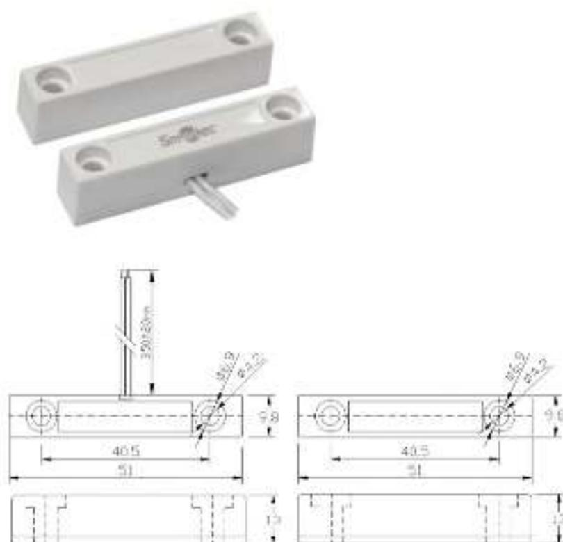
Извещатель магнитоконтактный ST-DM122NO-WT предназначен для коммутации линии питания 220 В переменного тока и может монтироваться на деревянные строительные конструкции (двери, окна, люки, ворота и т.д.). Данное устройство может использоваться, например, для автоматического включения света при открытии двери шкафа.
