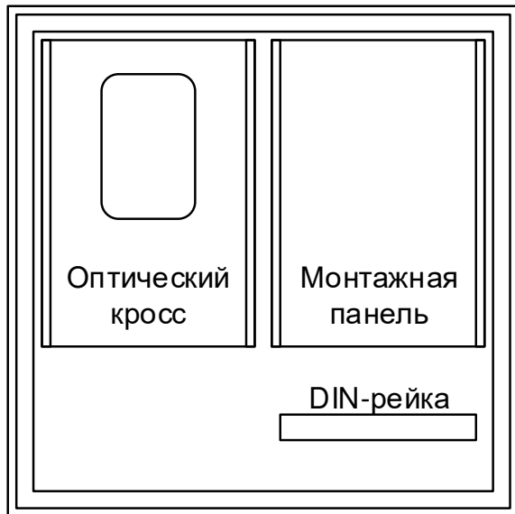
Схема расположения элементов внутри шкафа TFortis CrossBox-3
