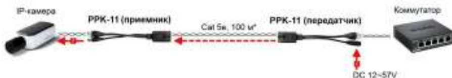
Рис. 3 Схема подключения комплекта PPK-11
