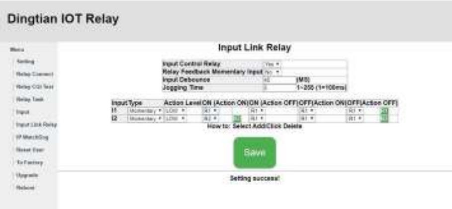
Рис.9 Страница Input link Relay WEB интерфейса, основные настройки.
