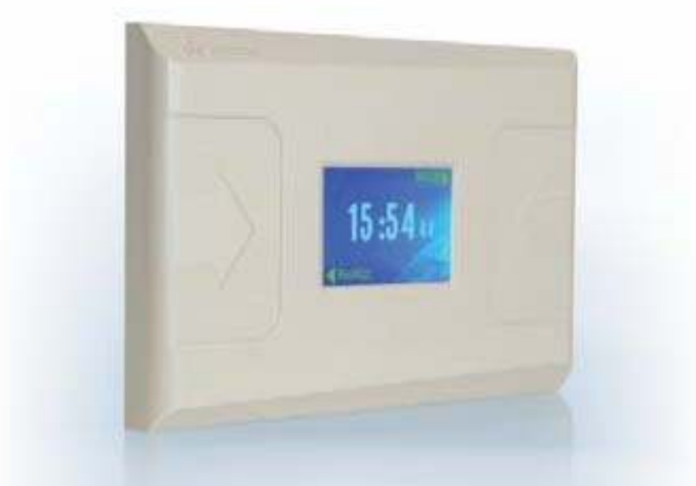
Рис. 1 Внешний вид контроллера регистрации PERCo-CR01 LICON
