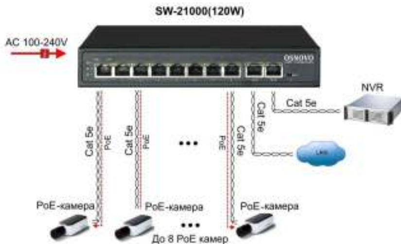
Рис.4 Типовая схема подключения коммутатора SW-21000(120W)
