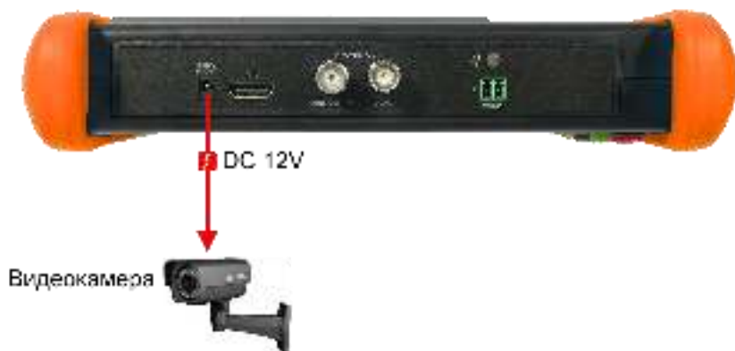
Рис. 4 Подключение питания DC 12V к видеокамере с использованием тестера
