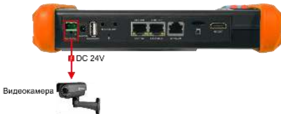
Рис. 5 Подключение питания DC 24V к мощной видеокамере с использованием тестера
