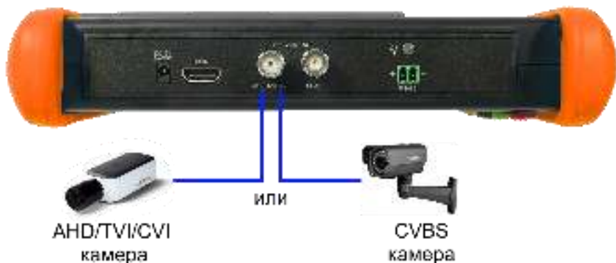
Рис.2 Разъемы для подключения AHD/CVI/TVI и CVBS видеокамер
