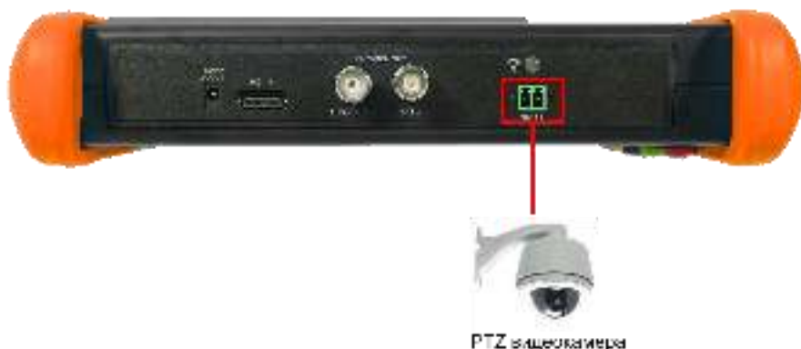
Рис.8 Подключение управляемой PTZ видеокамеры к тестеру
