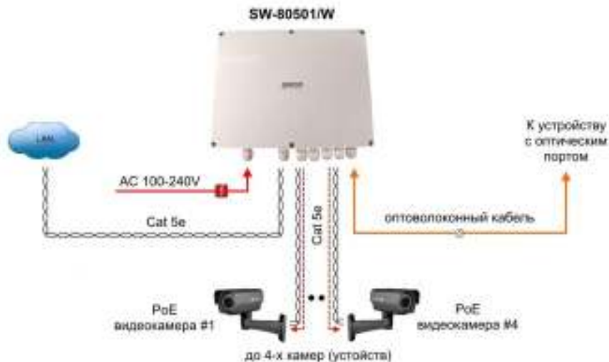
Рис.6 Типовая схема подключения коммутатора SW-80501/W
