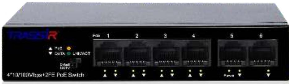
**TRASSIR TR-NS1106-60-4POE** – неуправляемый коммутатор с 4 PoE портами 10/100 Мбит/сек с возможностью подачи питания к подключенным устройствам по витой паре.
