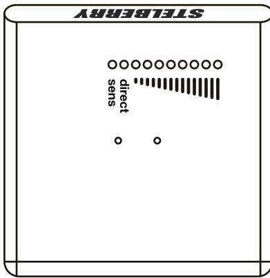
Регулировка направленности, чувствительности и режима направленности микрофона.
