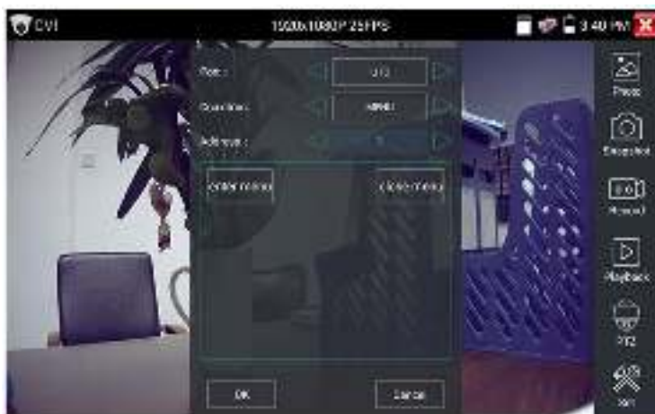
Рис. 94 Настройки для доступа к OSD меню видеокамеры по коаксиальному кабелю
