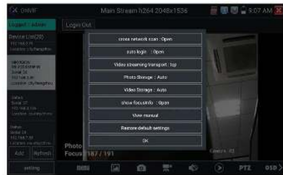
Рис. 35 Настройки приложения ONVIF
