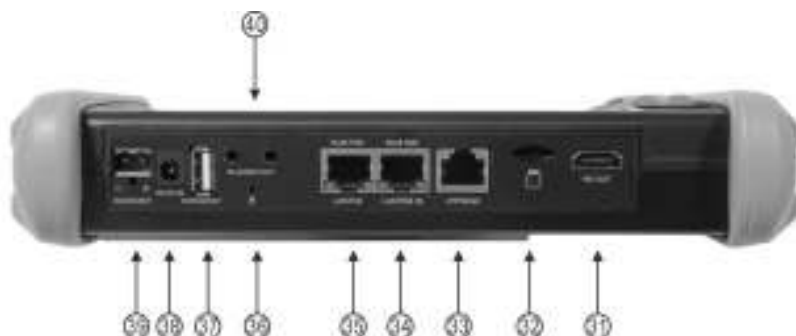
Рис. 6 Тестеры TIP-H-7, TIP-H-M-7 TIP-HOL-MT-7, разъемы, кнопки и индикаторы на нижней панели
