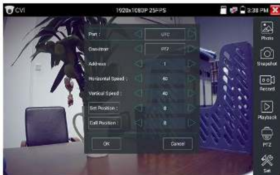
Рис. 90 Настройки для управления PTZ CVI видеокамерой по коаксиальному кабелю
