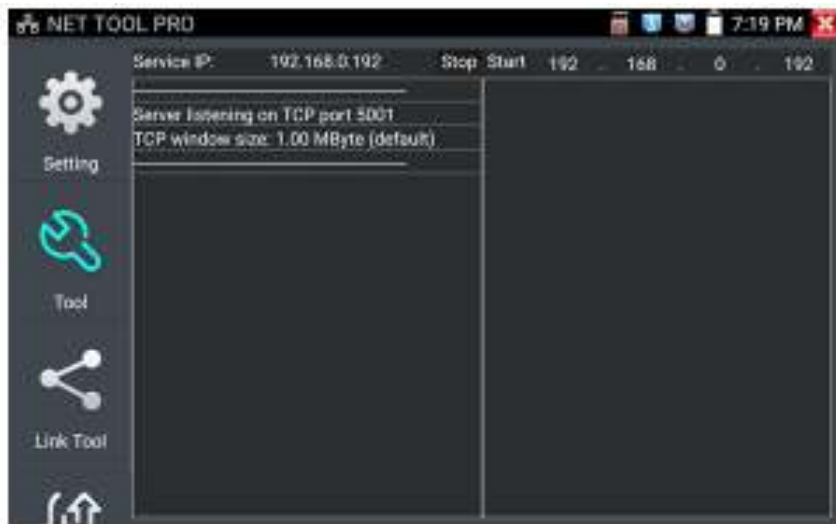
Рис. 105 Работа 1го тестера в режиме «сервер» при проверки пропускной способности сети
