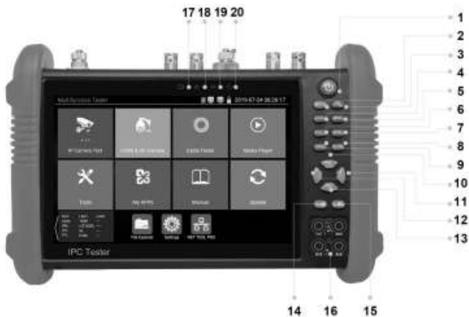
Рис. 4 Тестеры TIP-H-7, TIP-H-M-7, TIP-HOL-MT-7, разъемы, кнопки и индикаторы на передней панели
