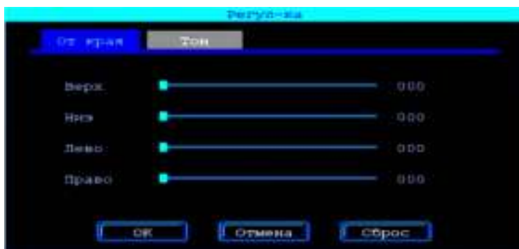
Рис.16 Настройка смещения видеокадра на экране монитора
