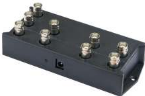
Рис.1 Разветвитель D-H108, внешний вид
