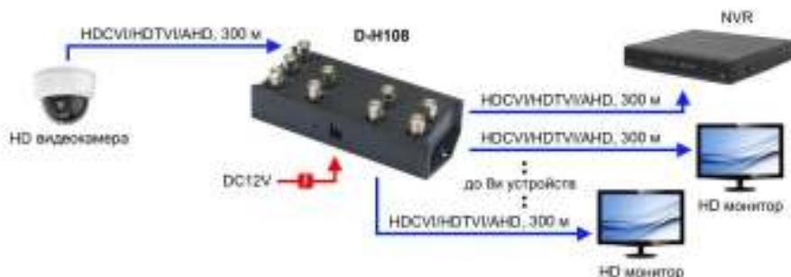
Рис.3 Схема подключения разветвителя D-H108
