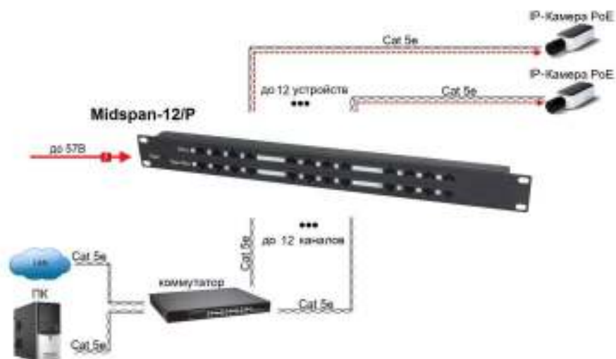
Рис.4 Схема подключения Midspan-12/P
