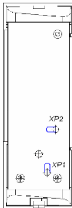
Рисунок 2. Расположение перемычки XP2 «номер считывателя» и перемычки XP1 «отключение концевого резистора»
