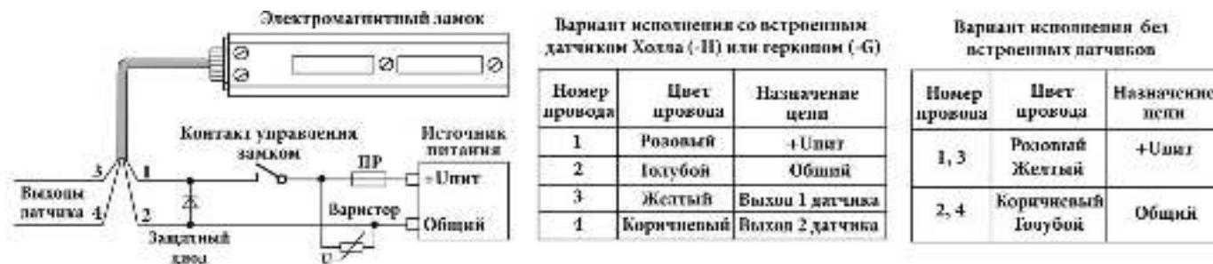
Рисунок 9 - Схема подключения замка
