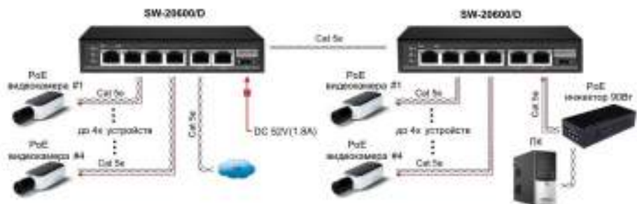
Рис.7 Схема каскадного подключения коммутатора SW-20600/D
