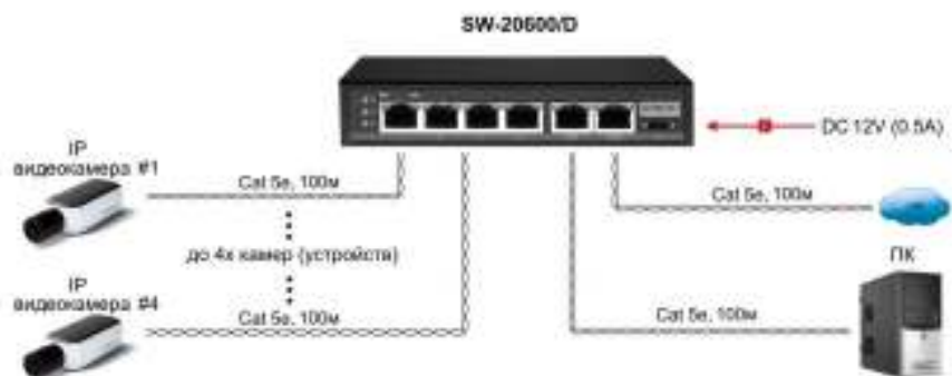
Рис.6 Схема подключения коммутатора SW-20600/D (без использования PoE)
