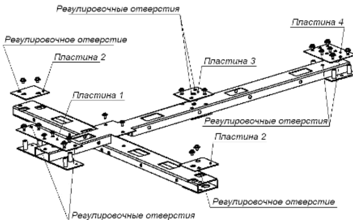
Рисунок 3 Схема сборки рамы. Шаг 2.
