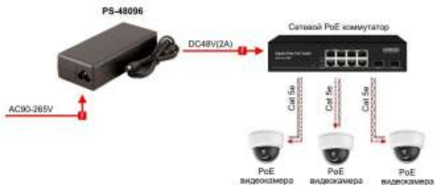
Рис.3 Типовая схема подключения блоков питания на примере PS-48096
