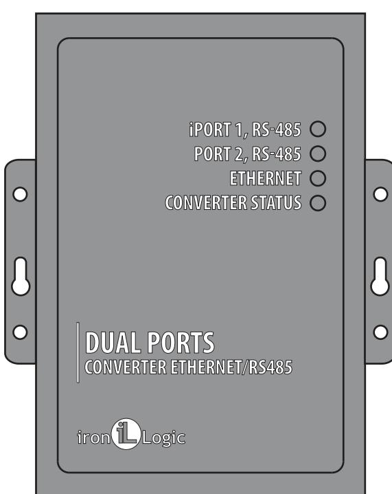
**ETHERNET** - отображает состояние подключения по локальной сети.
