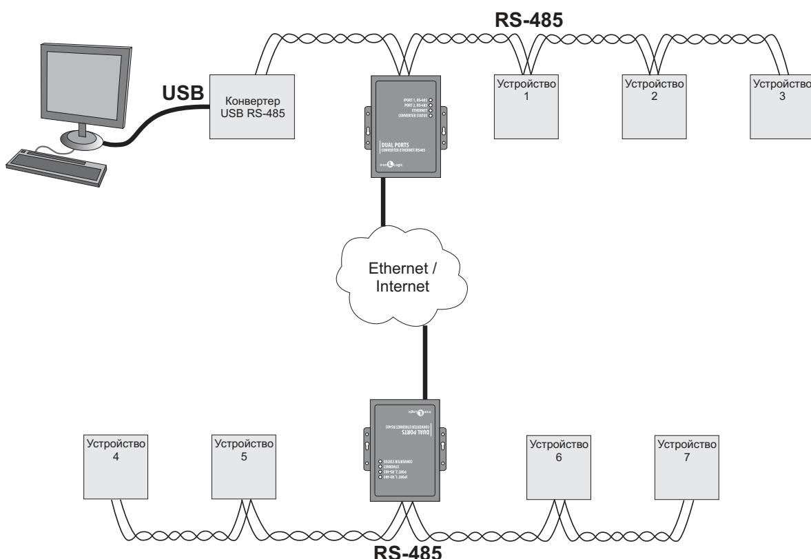
Пример конфигурации конвертеров для режима моста:
