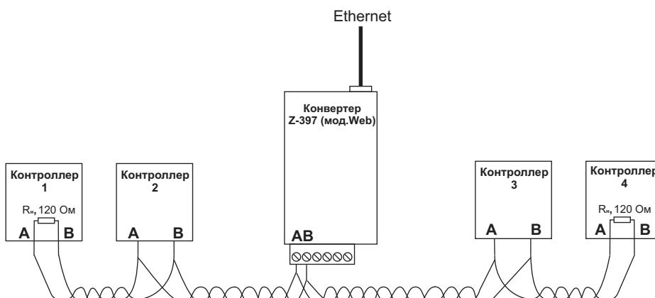
Пример схемы подключения конвертера в середине линии RS-485. Нагрузочное сопротивление подключать к Z-397 (мод.Web) не требуется. При большой длине линии связи необходимо объединить "земли" конвертера и контроллеров. Для этого можно использовать отдельный провод или пару проводов из
