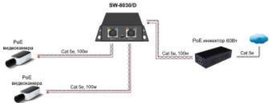
Рис.4 Типовая схема подключения коммутатора/удлинителя SW-8030/D в режиме питания от PoE инжектора
