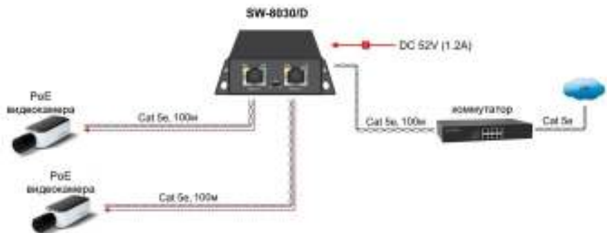
Рис.5 Схема подключения коммутатора/удлинителя SW-8030/D в режиме PoE инжектора
