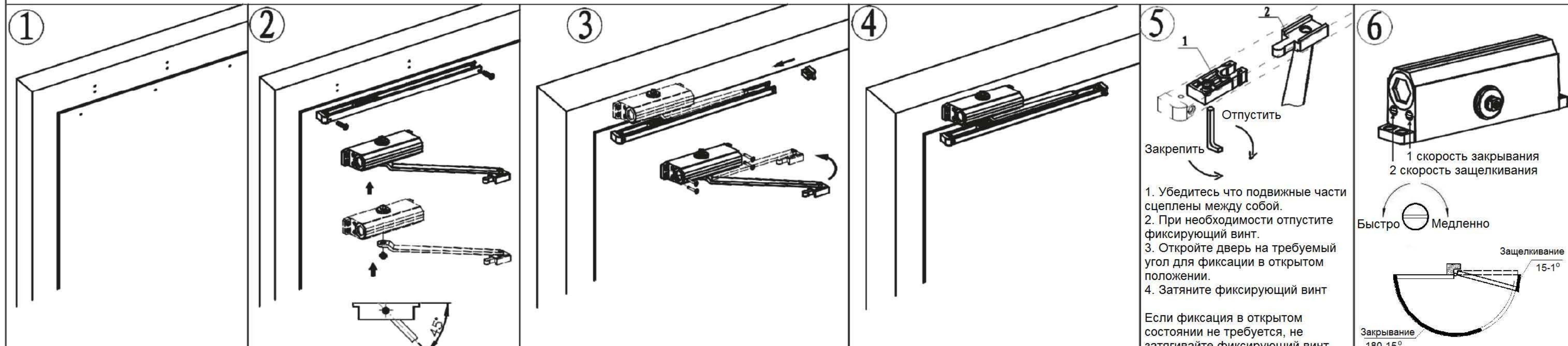
Разметьте и просверлите отверстия в дверной коробке и двери строго следуя размерам указанным выше
