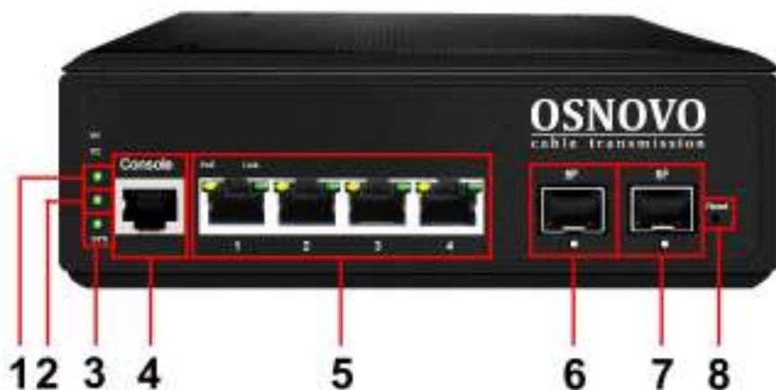
Рис.1 Коммутатор SW-80402/IL, разъемы, кнопки и индикаторы
