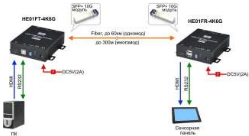
Рис.6 Схема подключения комплекта HE01F-4K6G-KS, управление через интерфейс RS232.
