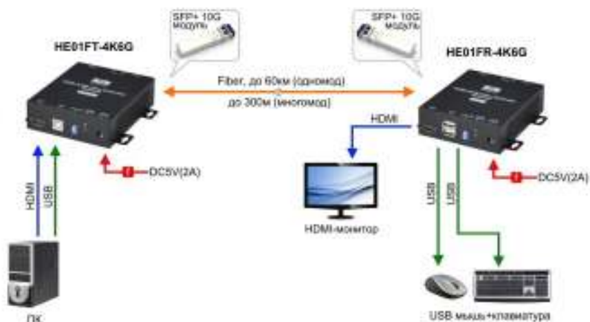
Рис.4 Типовая схема подключения комплекта HE01F-4K6G-KS.
