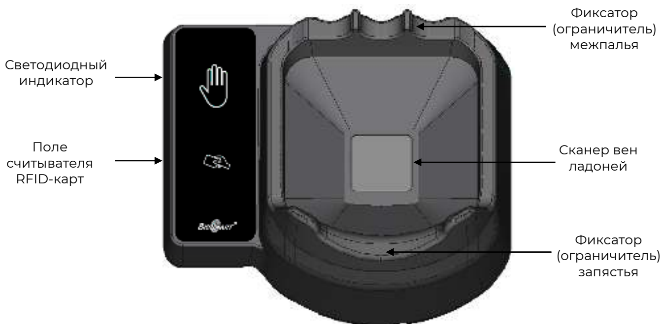
Рисунок 1 – Вид спереди и назначение основных элементов считывателя
