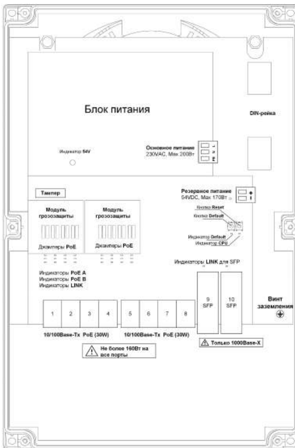
Рисунок 3.2 - Расположение элементов PSW -2G8F+
