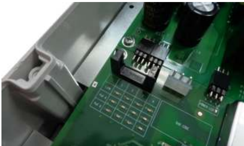
Рисунок 3.5.1 - Датчика вскрытия на плате
