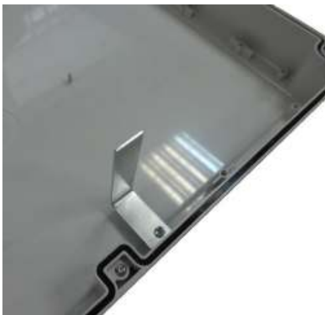
Рисунок 3.5.2 - Шторка датчика вскрытия на крышке блока
