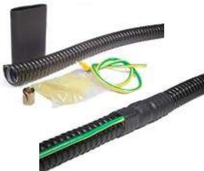
В случаях использования металлического рукава в ПВХ-изоляции и невозможности установить заземляющее устройство на вводную муфту ВМ или ВМУ, для сохранения степени защиты IP необходимо использовать термоусаживаемую муфту заземления Промрукав.
