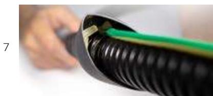
В образовавшуюся воронку всыпать термопластиковый клей и равномерно распределить его в манжете.
