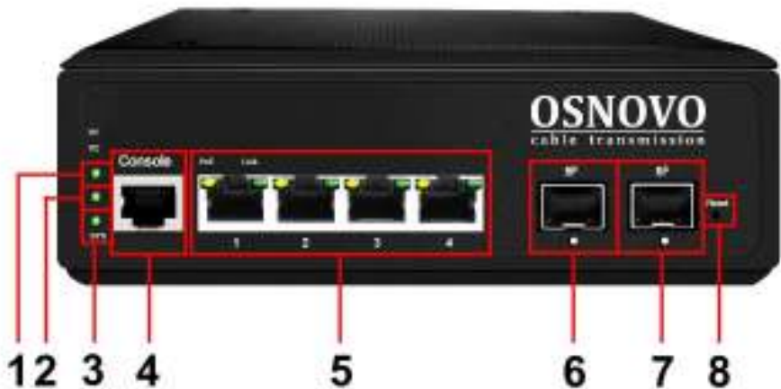
Рис.1 Коммутатор SW-80402/IL, разъемы, кнопки и индикаторы
