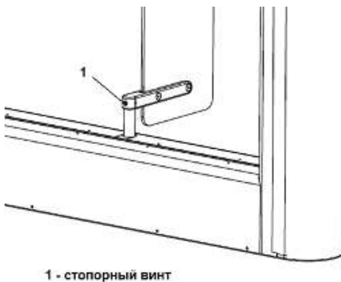
Рисунок 7 – Крепление стопорного винта
